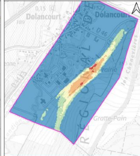
Calcul en FoS avec valeur minimum, pour un angle de rupture de 45°, avec nappe
