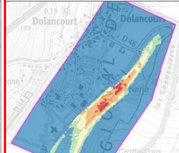
Calcul en FoS avec valeur minimum, pour un angle de rupture de 45°, avec nappe
