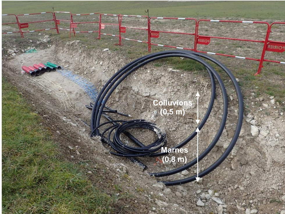
Illustration 15 – Affleurement de colluvions sur marnes dans une tranchée en pied de versant (secteur Nord-Est)
