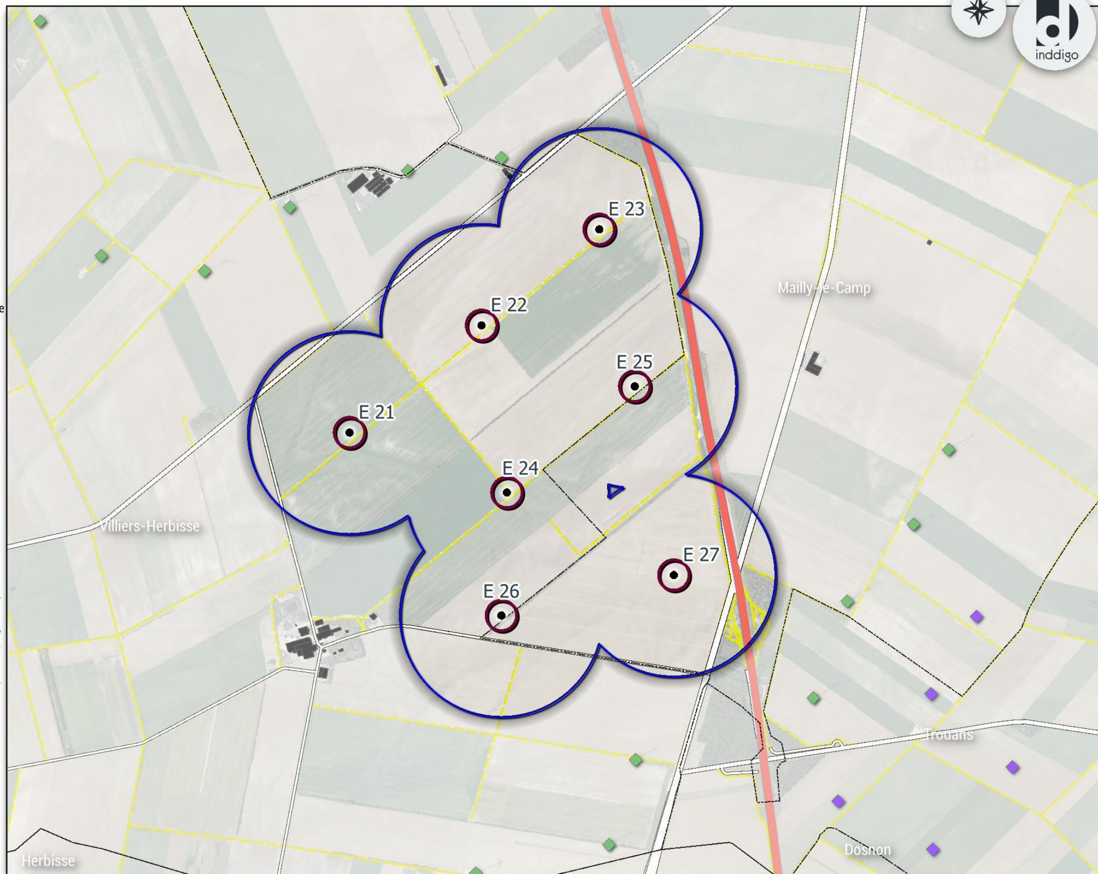
Carte 14 : Carte des risques du scénario « chute d'éléments de l'éolienne » et du scénario « chute de glace »
