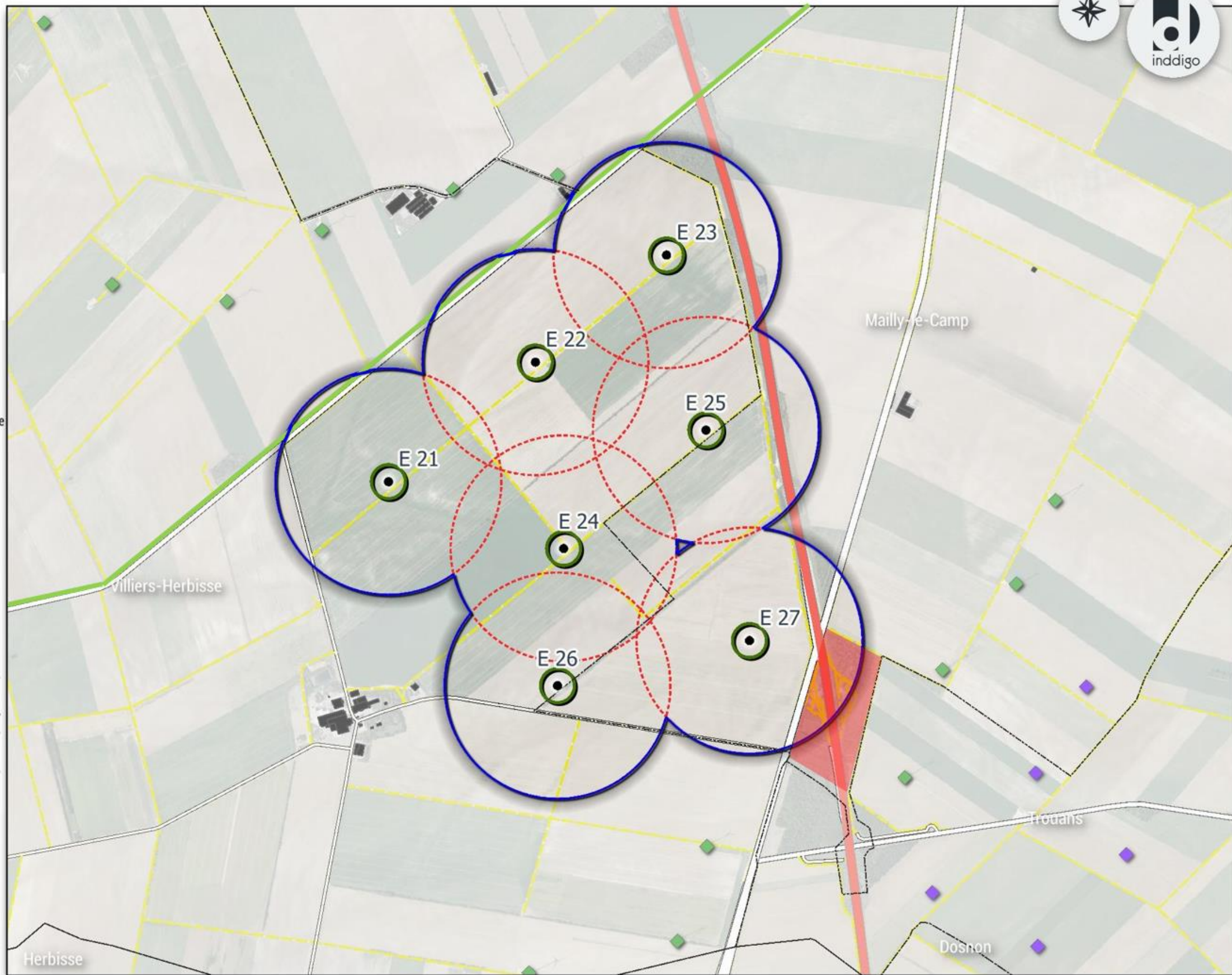
Carte 15 : Carte des risques du scénario « projection de pales ou de fragments de pales »
