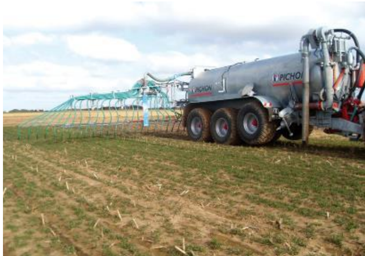
Figure 31 : Tonne munie d'une rampe à pendillards
