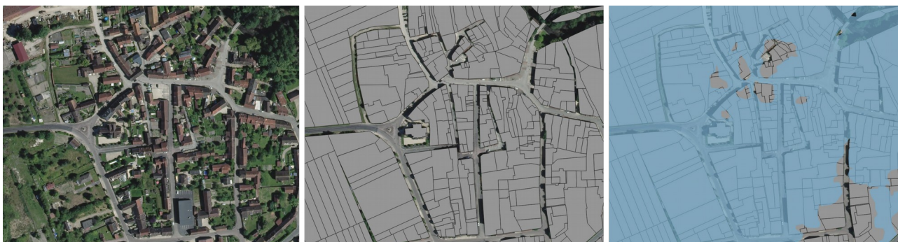
Illustration 13 - De gauche à droite, orthophotographie – superposition du parcellaire – superposition du parcellaire et de l'emprise de l'aléa à Crancey (source : IGN)
