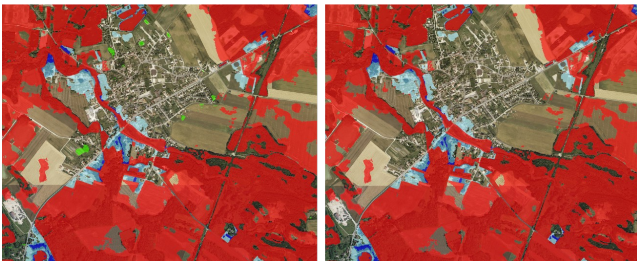
Illustration 15 - À gauche, le zonage réglementaire avec en vert les erreurs mineures manifestes de l'aléa ; à droite, le zonage réglementaire finalisé écartant ces erreurs à Saint-Just-Sauvage (source : IGN)
