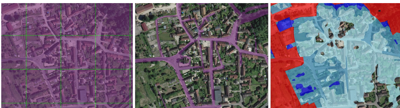
Illustration 14 - De gauche à droite, grille 100 mètres par 100 mètres – différence de la grille avec le parcellaire – zonage réglementaire finalisé à Crancey (source : IGN)
