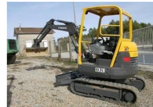
Photo 22 : Exemple de mini-pelle (Source : machineryzone.fr)
