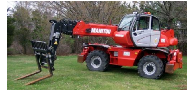
Photo 21 : Exemple de chariot rotatif (Source : freche-location.fr)
