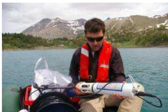
Figure 12. Matériel de mesure in situ, Echobsondeur pour rechercher la plus grande profondeur à gauche, sonde multiparamètres à droite.
