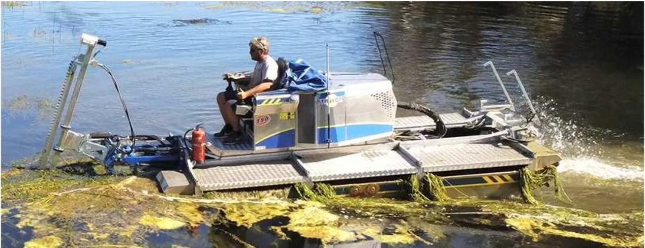
Figure 11 : faucardage mécanique d'un étang (source : etang-solution.com)
